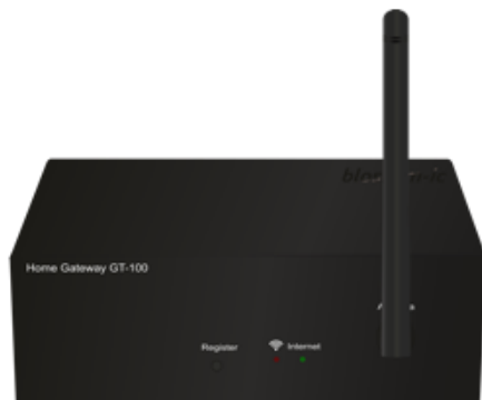
Abbildung 4: Gateway-Einheit – zentrale Steuereinheit für das Hera + -System
