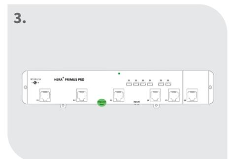
3. Register-Taste an der Leiste kurz drücken. Die Leiste muss zuvor auf dem Gateway registriert werden.
