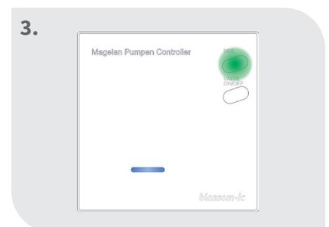
3. „Register“-Taste am Pumpencontroller 3 Sekunden drücken
