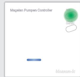
Register-Taste am Pumpencontroller 3 Sekunden drücken
